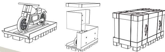
Immobilisation de la moto garantie par des attaches spécifiques permettant de la sangler à l'intérieur de la caisse.
