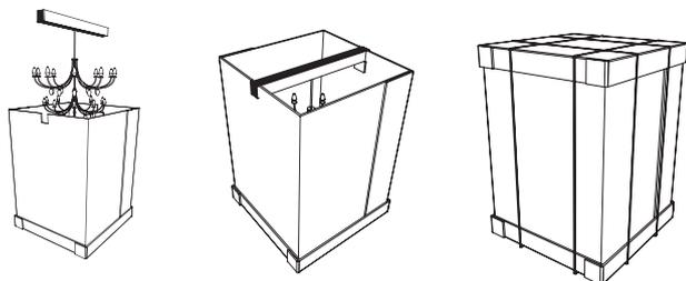
Le lustre est suspendu dans la caisse grâce à une barre horizontale. La protection et la stabilité du lustre sont garanties pendant le transport.
